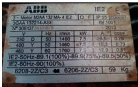
**Img 5. ESEMPIO DI targhetta sul MOTORE**
