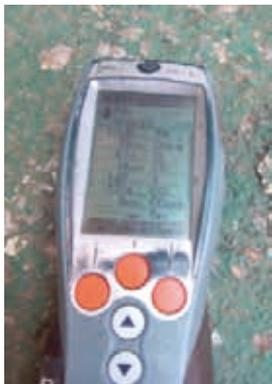
IMG 6. ANALIZZATORE DI COMBUSTIONE
